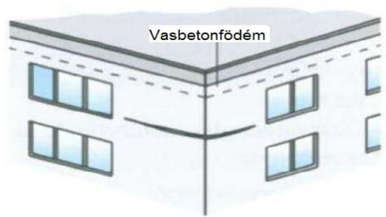
Vízszintes repedés a külső sarkon (Schubert, 2004.)
